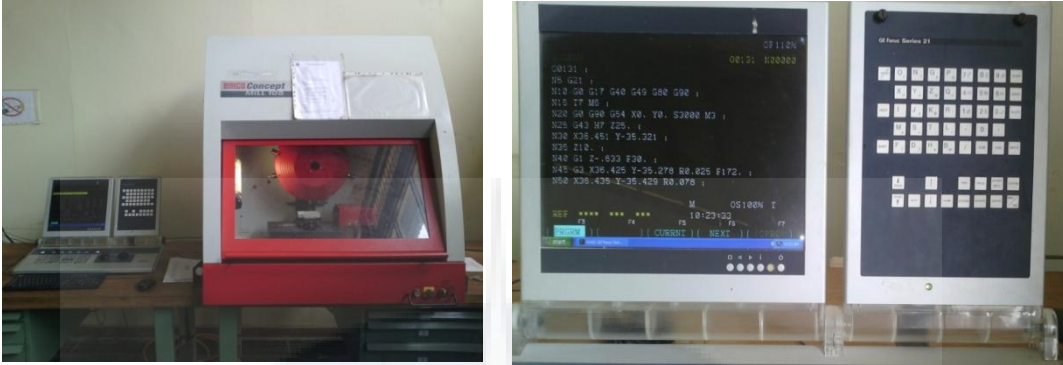
Mesin Milling CNC EMCO Concept Mill 105 dan Pemasukan program
