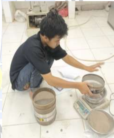
Penimbangan agregat berukuran saringan
