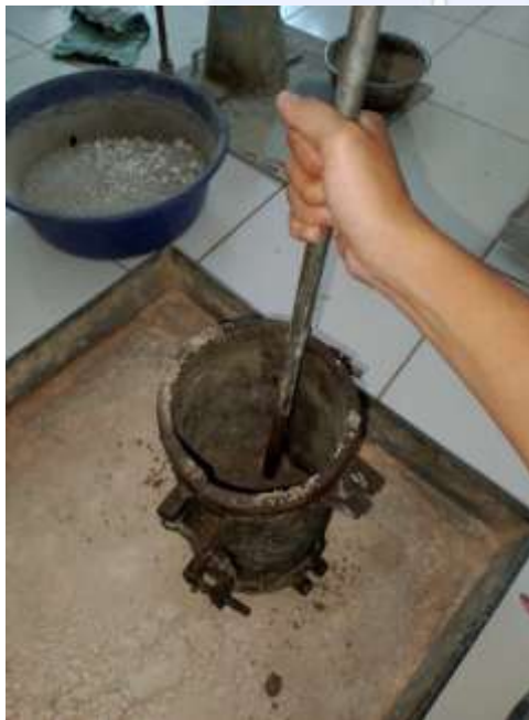
Proses penumbukan 25 kali per lapisan
