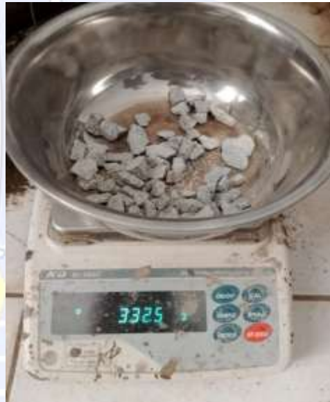
Penimbangan agregat berukuran saringan
