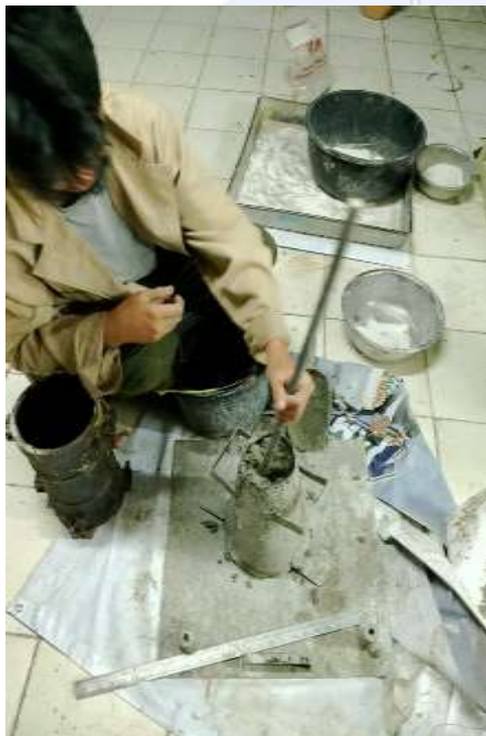
Tumbuk senyak 25 kali campuran beton
