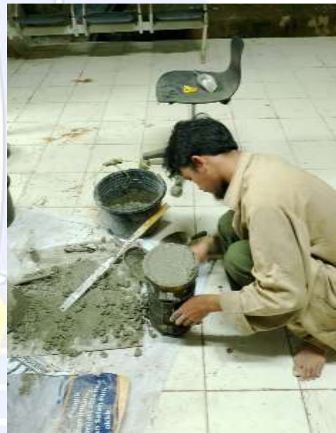
Cetak campuran beton dalam silinder
