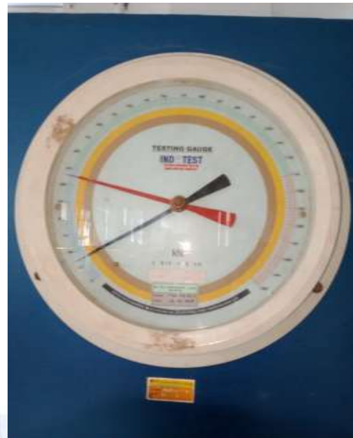
Proses penunjukan nilai kuat tekan beton
