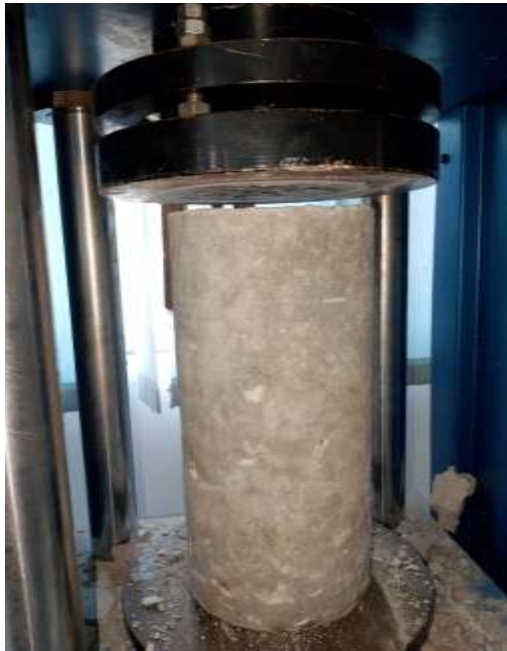
Perletakan beton pada mesin pengujikuat tekan
