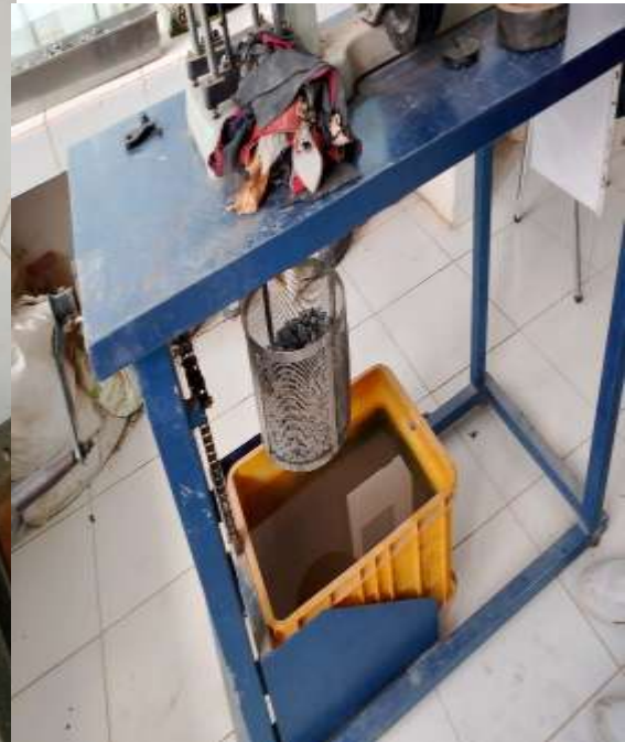
Masukkan benda uji dalam keranjang
