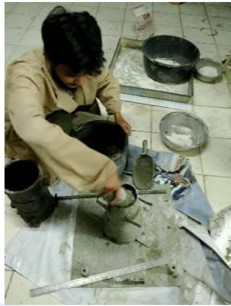
Masukan campuran beton dalam corong
