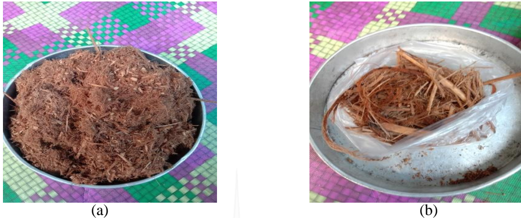
Gambar 4.3 Hasil cacahan (a) Tercacah sempurna, dan (b) Tidak tercacah sempurna
