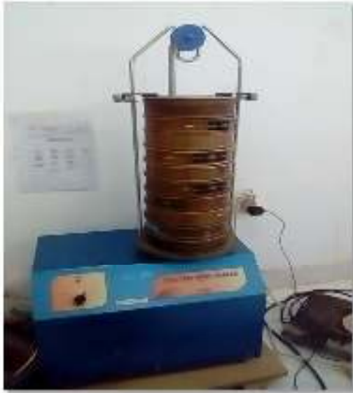
Gambar F.11 Pengujian Analisis Saringan Selama 15 Menit Pada Shieve Sheker
