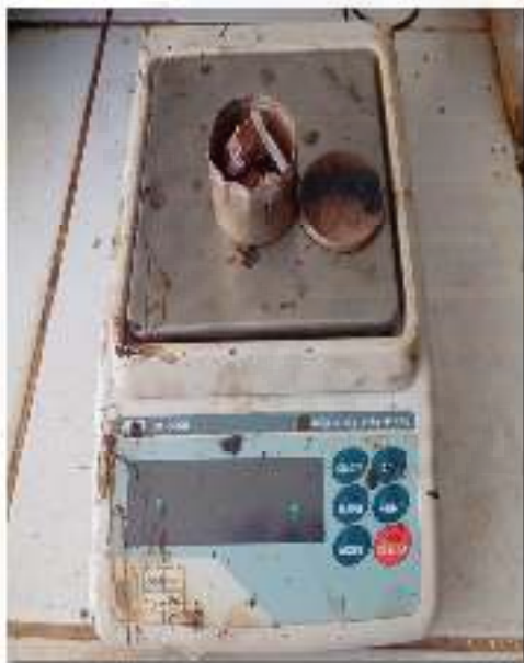
Gambar F.5 Penimbangan Sampel Untuk Kadar Air
