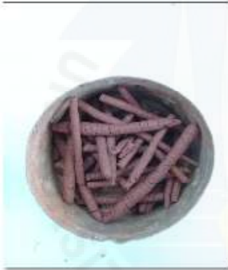
Gambar F.9 Pembuatan Alur Pada Benda Uji
