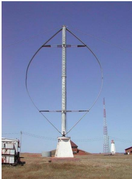
**Gambar 22.** Turbin Angin Sumbu Vertikal
