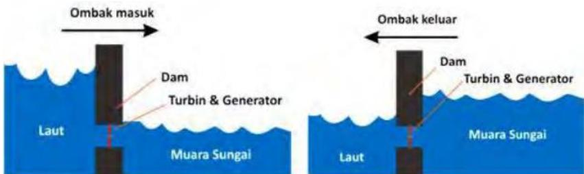
**Gambar 40.** Proses Kerja Bendungan Pasang Surut
