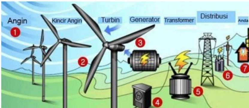
**Gambar 23.** Sistem Kerja Pembangkit Listrik Tenaga Angin Secara Umum
