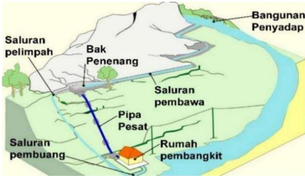
**Gambar 34.** Skema Pembangkit Listrik Tenaga Minihidro/Mikrohidro
