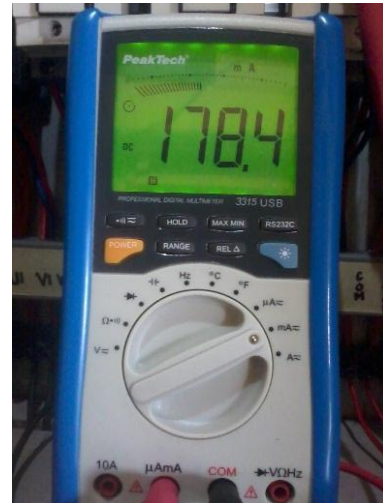
Gambar 2 Nilai pengukuran arus pada rangkaian kontrol saat running
