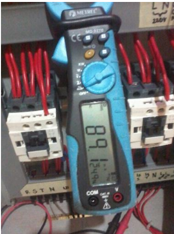
Gambar 1 Nilai pengukuran arus pada rangkaian kontrol saat standby
