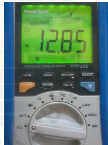
Gambar 4 Nilai pengukuran catu daya PLCmikro pada saat running
