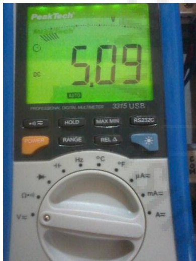
Gambar 3 Nilai pengukuran Catu daya pada sisi IC regulator
