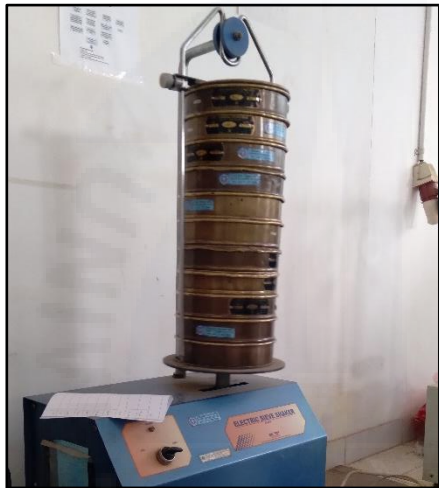
Gambar K.9 Pengujian Analisis Saringan menggunakan Sieve Shaker
