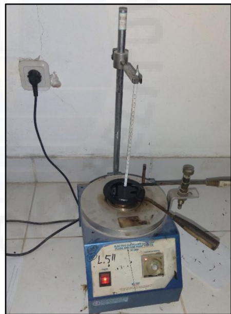
Gambar K.16 Pengujian Titik Bakar Aspal
