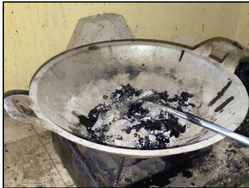
Gambar K.17 Proses Pencampuran Aspal dan Agregat
