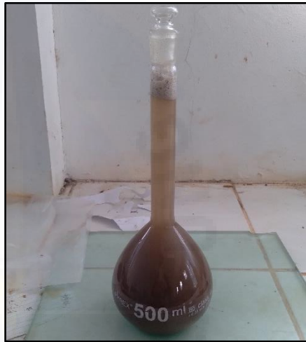
Gambar K.10 Pengujian Berat Jenis Agregat Halus
