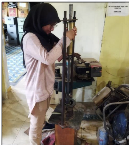
Gambar K.19 Proses Pencetakan Benda Uji
