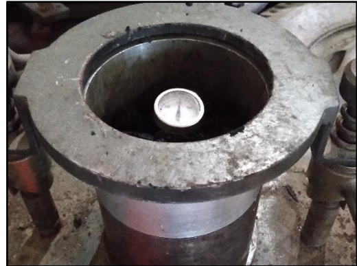
Gambar K.18 Pengecekan suhu campuran aspal sebelum dicetak
