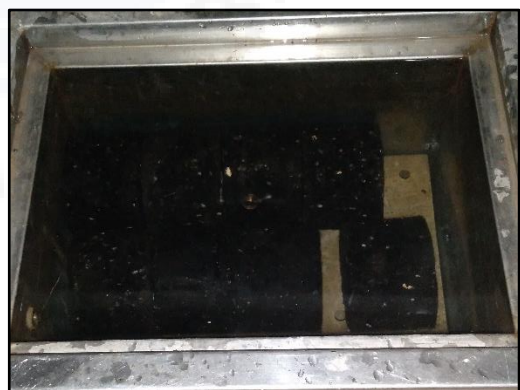
Gambar K.22 Proses Perendaman Benda Uji di Water Bath
