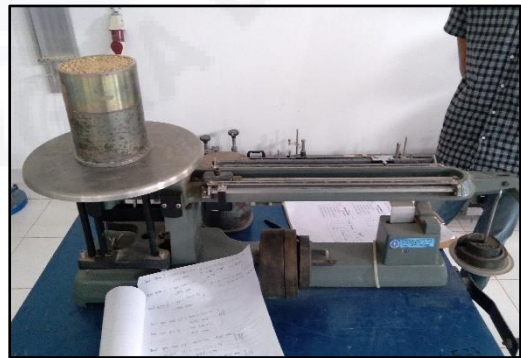
Gambar K.12 Pengujian Berat Isi Agregat
