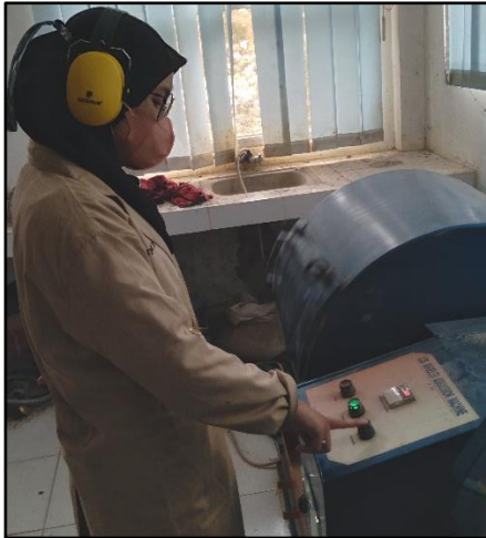
Gambar K.7 Pengujian Los Angeles Agregat Kasar
