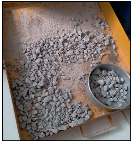
Gambar K.8 Agregat Kasar setelah Pengujian Los Angeles
