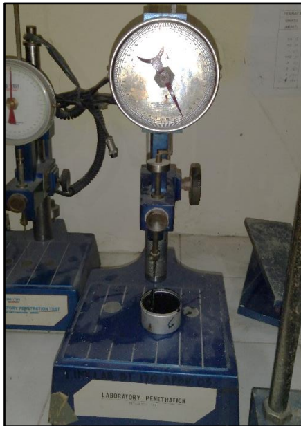
Gambar K.13 Pengujian Pengujian Penetrasi Aspal
