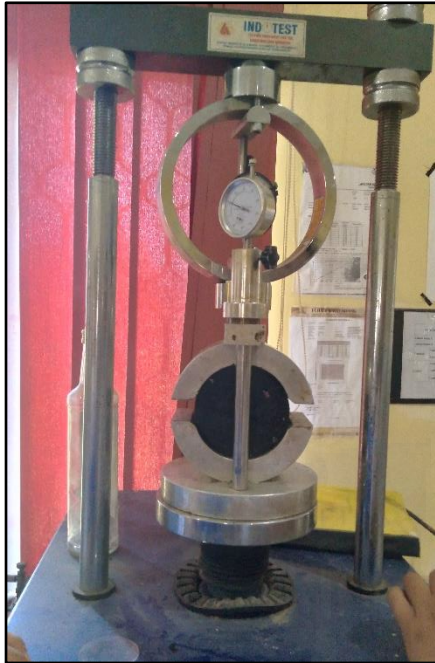
Gambar K.23 Pengujian Marshall pada Benda Uji
