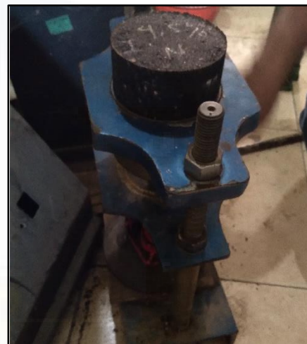
Gambar K.20 Proses Pelepasan Benda Uji dari Cetakan (Mol)
