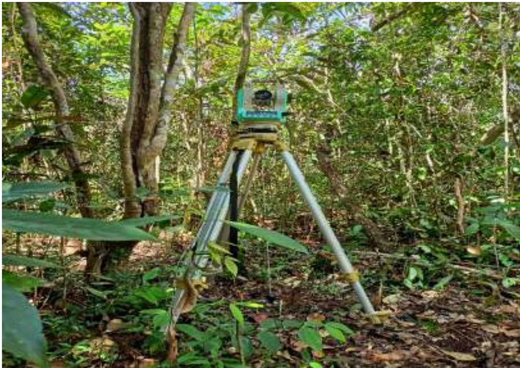
Gambar 3. 6 Alat Theodolite dalam keadaan centring
