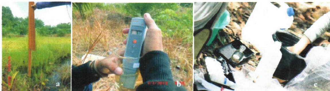
Gambar 14 Kegiatan pengukuran parameter fisik kimia air di Riding Panjang: a). pengkuran kedalaman air dengan tongkat berskala/kedalaman; b). pengukuran pH air dan c). pengukuran DO air dengan DO Kit meter (Mahasiswa/wi Agroteknologi Angkatan Kedelapan 2013)
