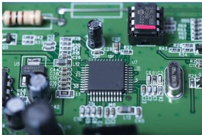
Gambar 3.5 Resistor dan Tipe SMD IC (Perangkat Pemasangan Permukaan)
