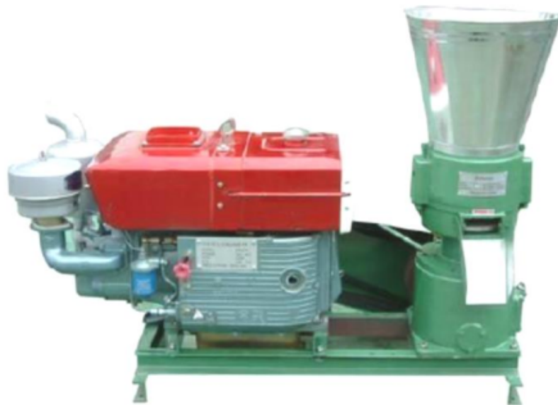
Gambar 4.3 Mesin Penggiling untuk Memperkecil Ukuran Partikel
