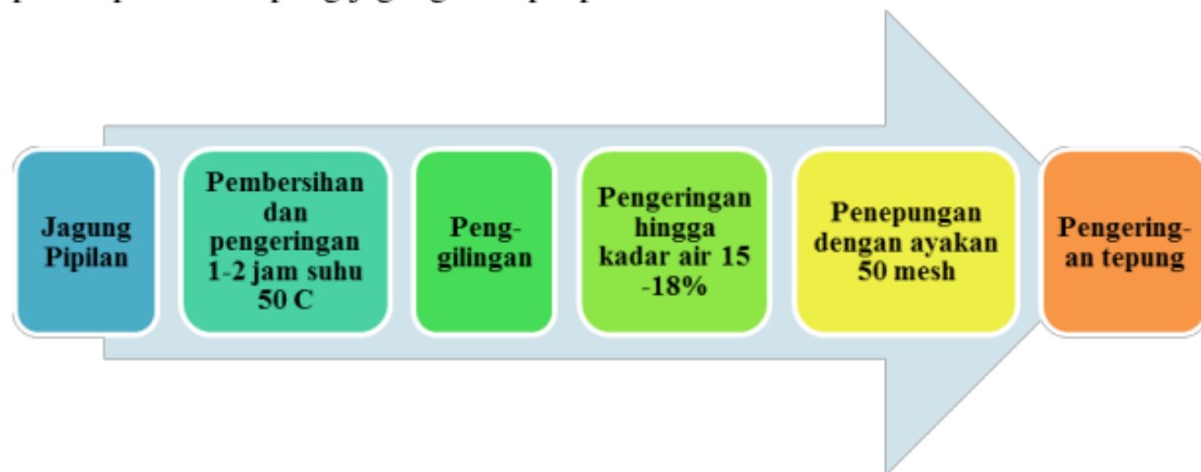
Gambar 2.3 Diagram Alir Proses Pembuatan Tepung Jagung
