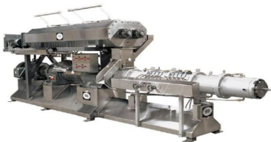
Gambar 4.4 Contoh Mesin Ekstruder Pencetak Pakan Ikan
