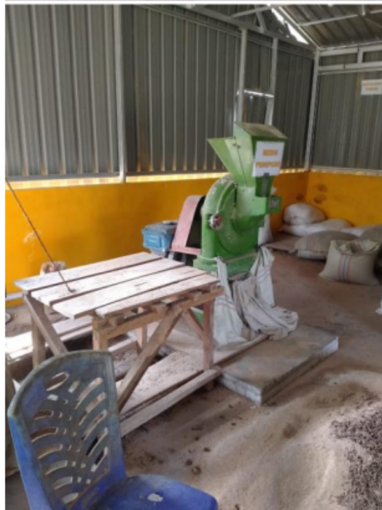
Gambar 4.5 Mesin Pencetak Pakan Terapung (Kiri) dan Mesin Penepung Bahan Penyusun Pakan
