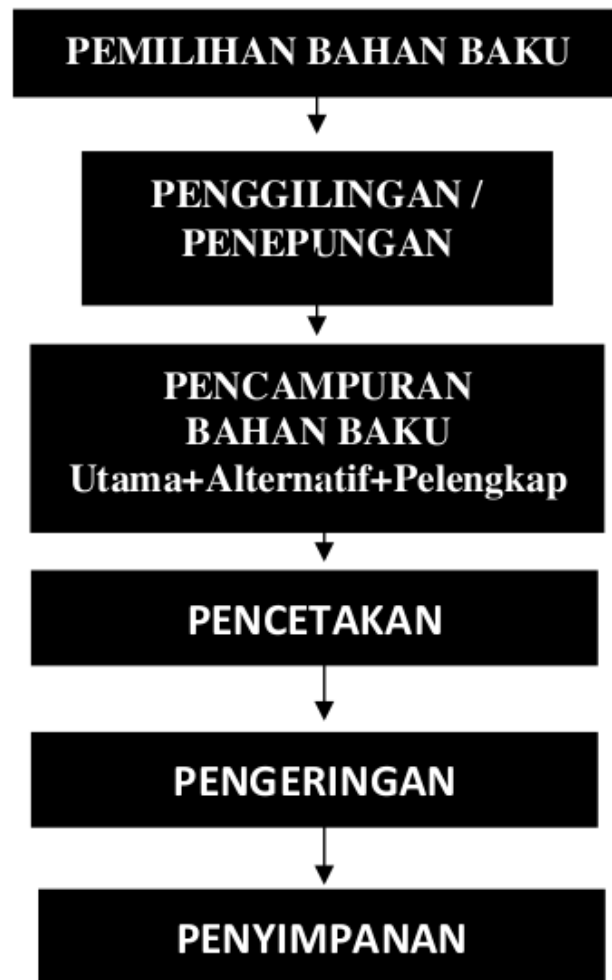
Gambar 4.6 Diagram Proses Pembuatan Pakan Ikan Mandiri
