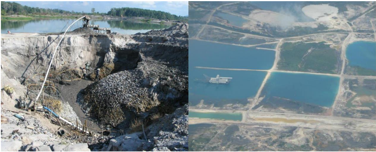
Gambar 3. Penambangan timah di darat (a) Tambang Inkonvensional; (b) Kapal Keruk Darat Sumber: Dokumentasi Nurtjahya 2004
