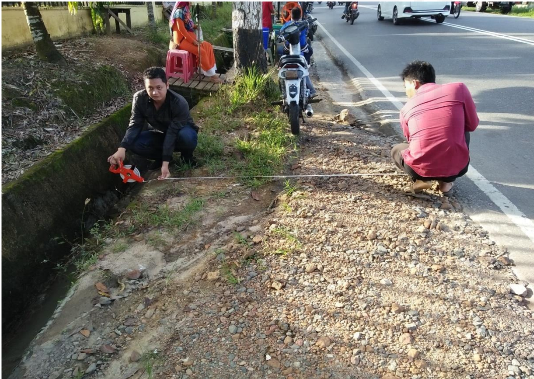
Gambar L.D.2 Foto Pengukuran Lebar Bahu Jalan Jenderal Sudirman
