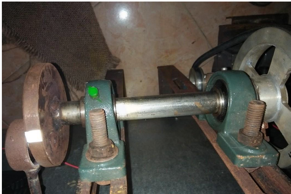
Gambar penempelan double tip pada permukaan poros eksentrik agar putaran terbaca pada sensor tachometer
