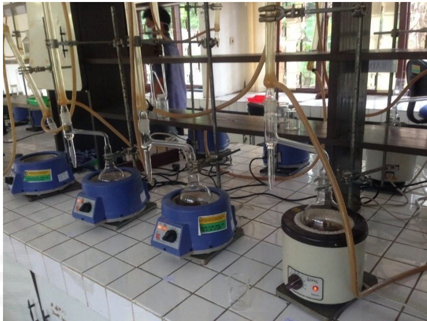
Gambar proses destilasi kadar air
