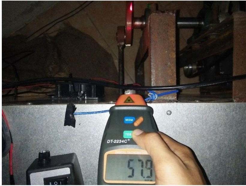
Gambar pengaturan kecepatan putaran 50 RPM
