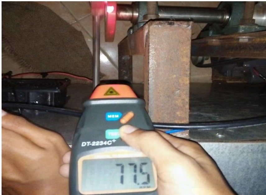
Gambar pengambilan kecepatan putaran pada 70 RPM
