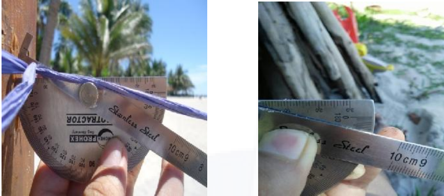
Gambar 7. Pengukuran kemiringan pantai
