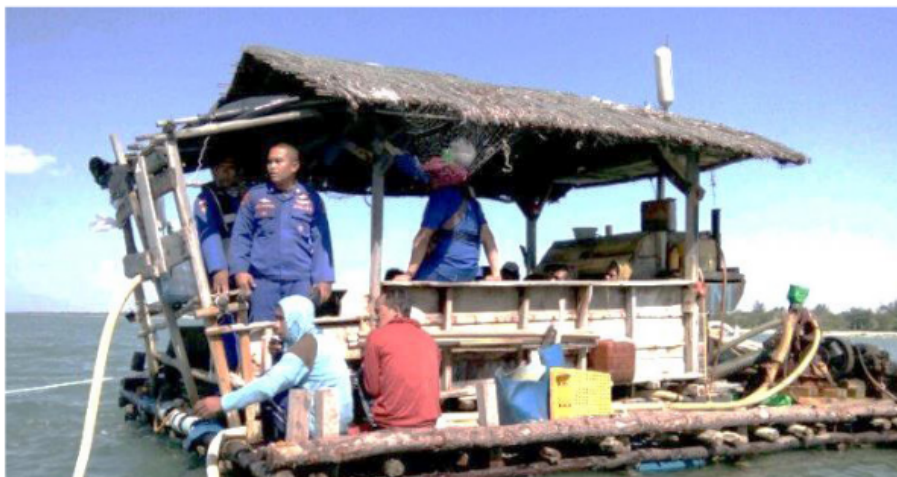
Gambar 4.3. Ponton Apung Penambang Timah Ilegal di Perairan.
