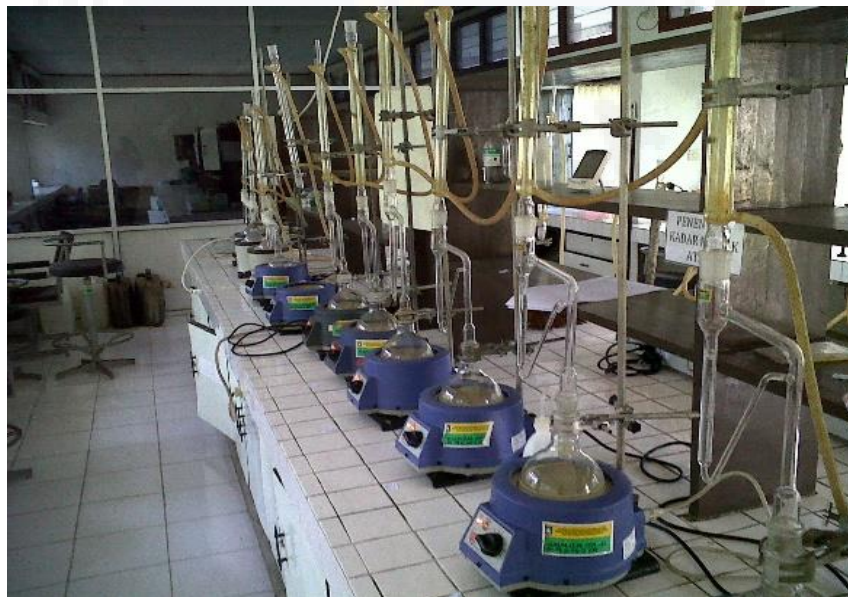
Gambar proses destilasi kadar minyak atsiri
