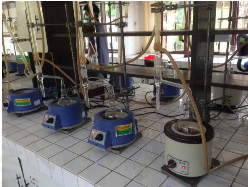
Gambar proses destilasi kadar air
