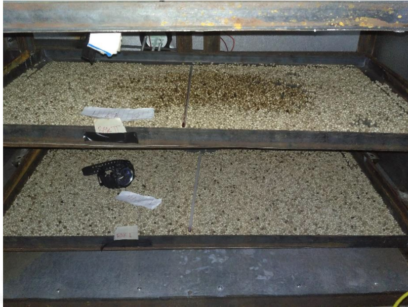
Gambar peletakan termometer
