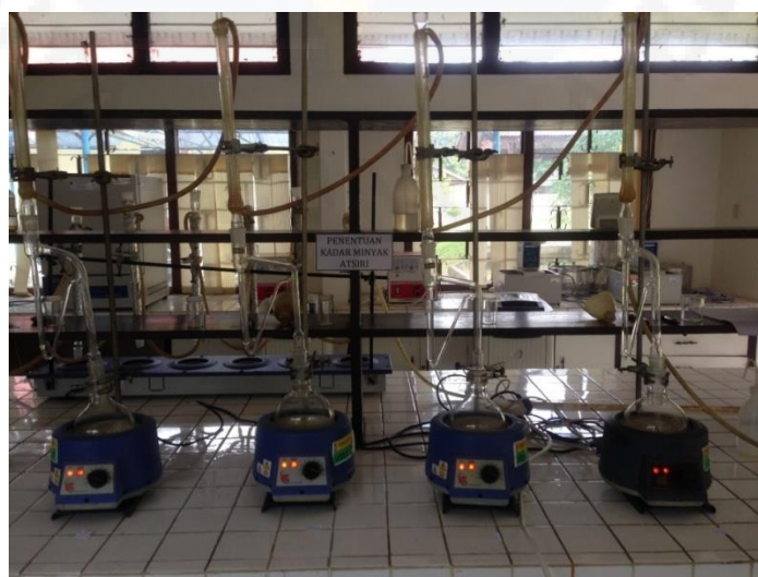
Gambar proses destilasi kadar minyak atsiri
