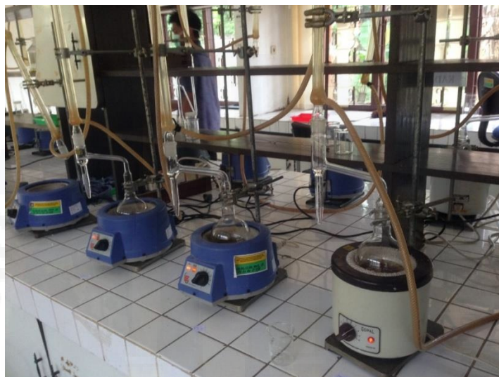
Gambar proses destilasi kadar air
