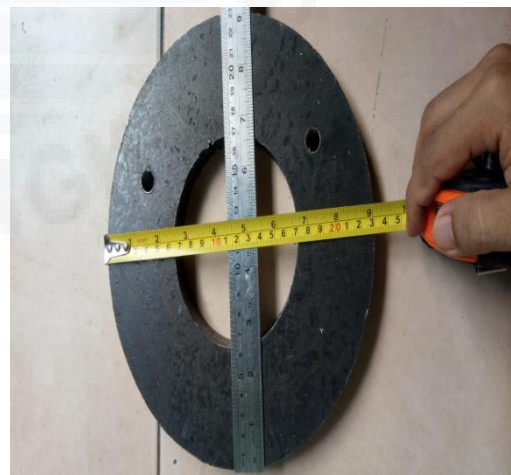
proses pengukuran flange .
