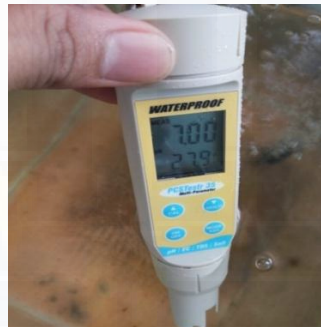
Pengukuran pH ( Digital )
