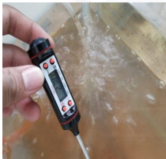
Pengukuran Suhu ( Digital )
