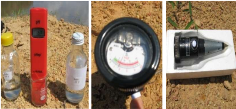
Gambar 14. Pengukuran pH air dan tanah di lokasi kegiatan penerapan IPTEKS menggunakan alat pH meter.
