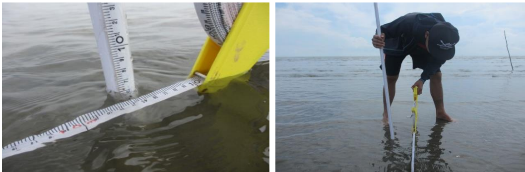
Gambar 2. Pengukuran Kedalaman Perairan dengan Pipa Skala
