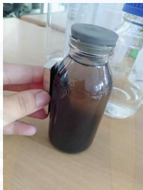
Gambar interaksi antara komposit kaolin:magnetit dengan medan magnet luar
