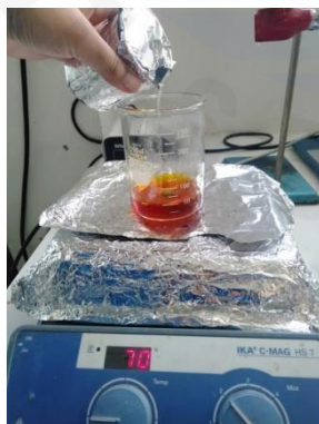
Gambar larutan FeSO 4 .7H 2 O dituangkan pada larutan FeCl 3
