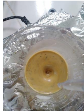
Gambar campuran kaolin + \text{FeSO}_4 \cdot 7\text{H}_2\text{O} + \text{FeCl}_3 ditetesi dengan \text{NaOH}
