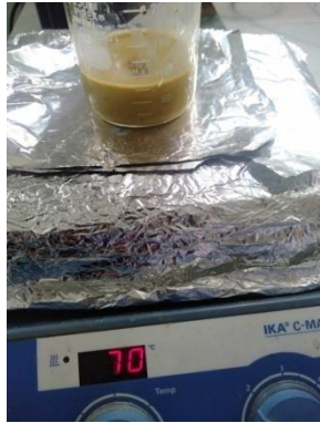
Gambar campuran kaolin+larutan \text{FeSO}_4 \cdot 7\text{H}_2\text{O} +larutan \text{FeCl}_3
