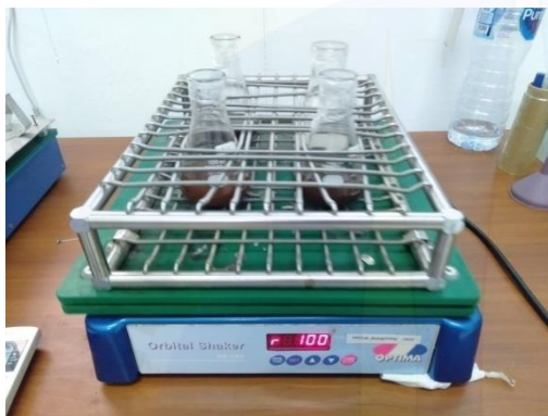
Gambar air sumur+adsorben diaduk menggunakan orbital shaker
