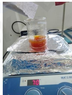
Gambar kaolin dimasukkan pada campuran larutan FeSO 4 .7H 2 O dan larutan FeCl 3
