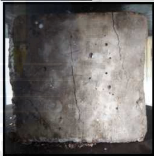
Mortar bata merah tumbuk setelah diuji
