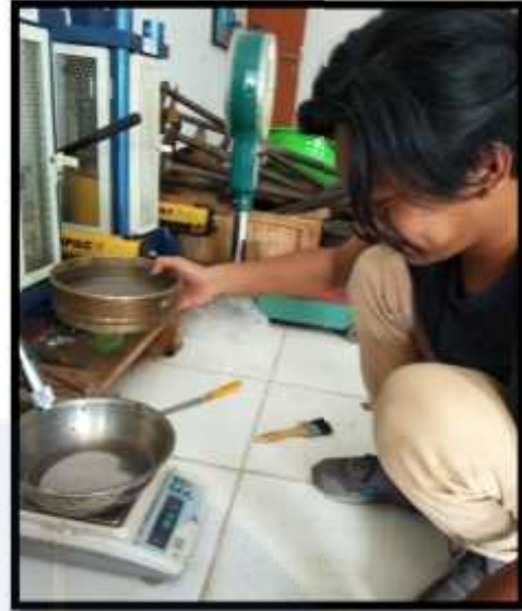
Menimbang agregat halus yang telah disaring
