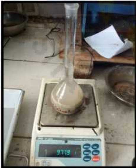
Piknometer + air + benda uji
