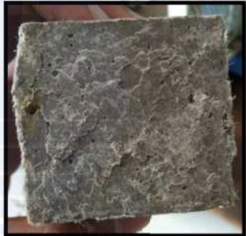
Papercrete bata merah tumbuk setelah diuji
