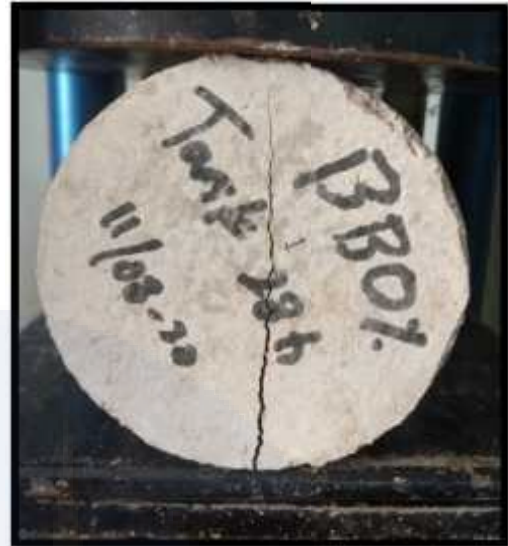
Mortar bata merah tumbuk setelah dilakukan pengujian
