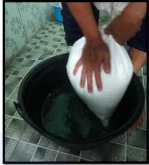
Pemerasan bubur kertas dengan Bantuan kain
