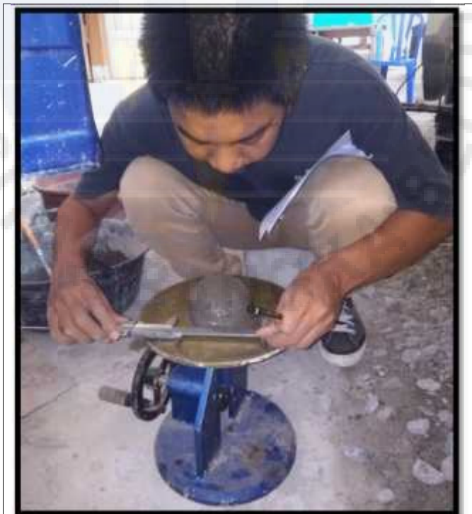
Pengukuran diameter sebelum dilakukan pengujian menggunakan jangka sorong
