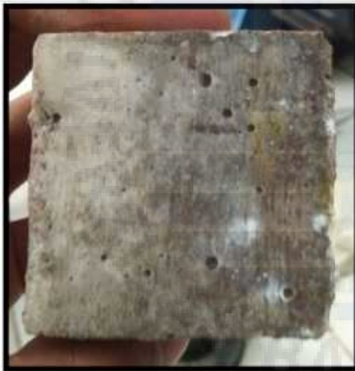
Mortar bata merah tumbuk sebelum diuji
