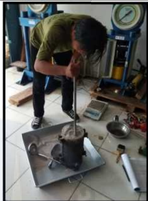
Proses penumbukan benda uji
