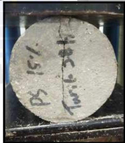
Papercrete pasir setelah dilakukan pengujian
