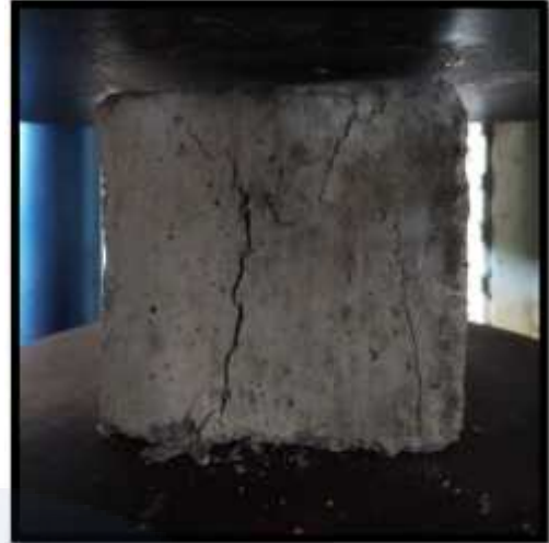
Mortar pasir setelah diuji
