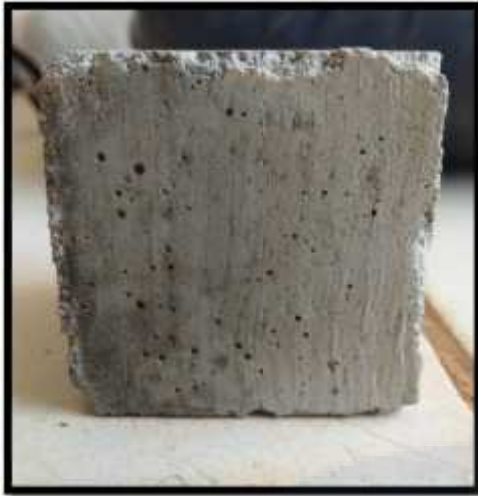
Mortar pasir sebelum diuji
