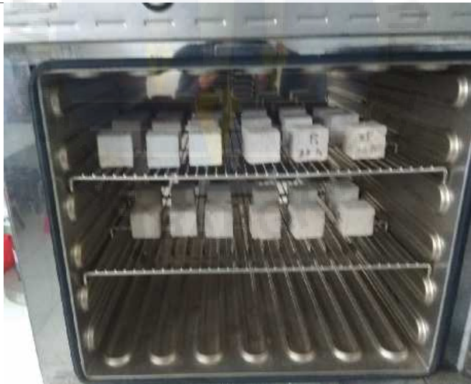
Benda uji dioven selama 24 jam
