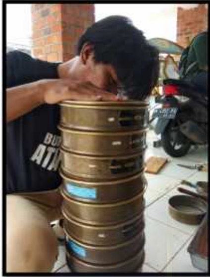
Penyaringan agregat halus
