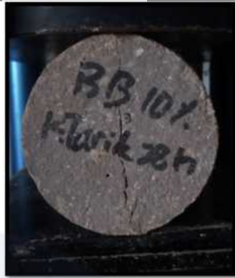
Papercrete bata merah tumbuk setelah dilakukan pengujian
