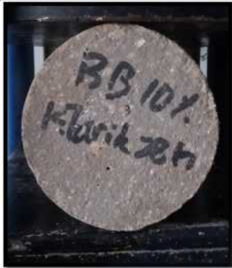
Papercrete bata merah tumbuk sebelum dilakukan pengujian
