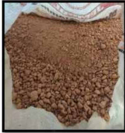
Gambar 3.4 Batu bata merah yang telah dihancurkan
