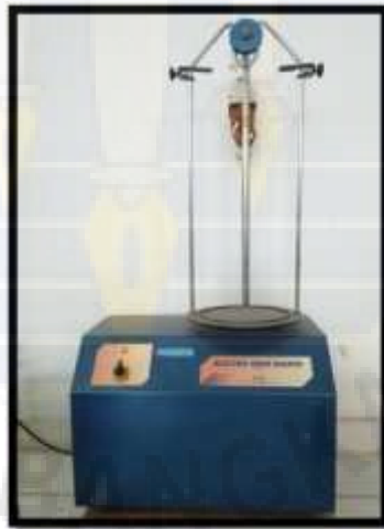
Gambar 3.15 Alat pengguncang saringan
