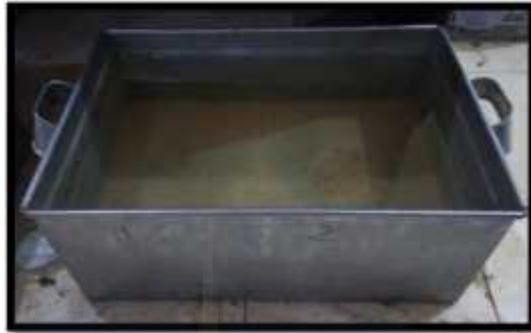
Gambar 3.10 Bak perendaman benda uji
