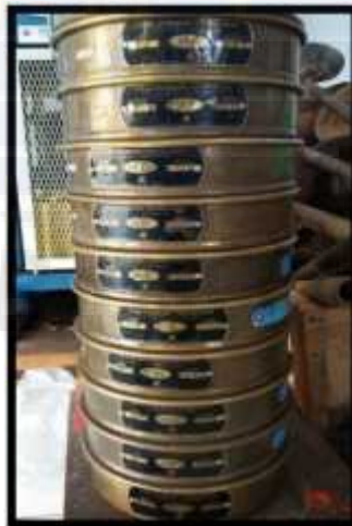
Gambar 3.7 Saringan yang digunakan dalam pengujian analisis saringan agregat halus
