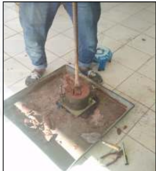
Gambar F.16 Pembongkaran benda uji Dari dalam mol
