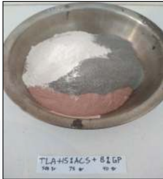
Gambar F.6 Pencampuran bahan tambah ACS dan LG pada tanah asli
