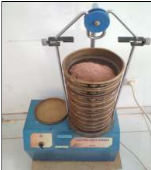
Gambar F.5 Pengguncangan sampel pada mesin Sieve shaker
