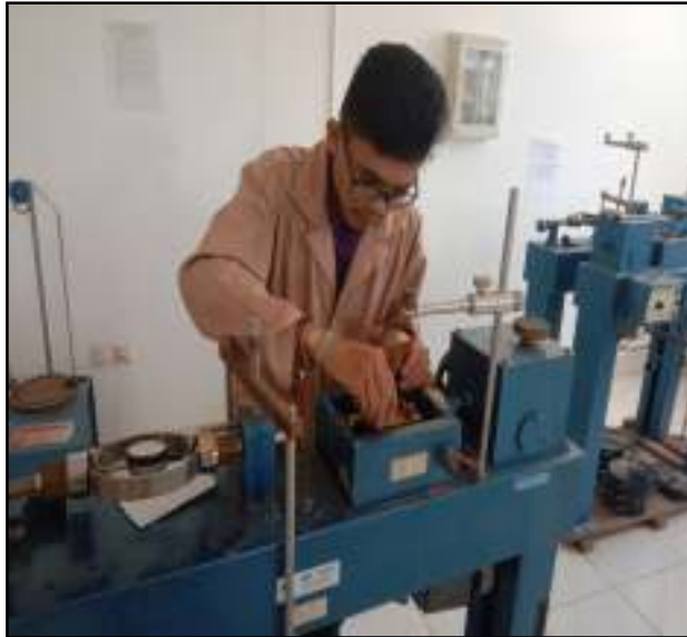
Gambar F.17 Proses memasukkan sampel ke dalam kotak geser
