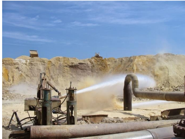
Gambar 2.4 Metode Tambang Semprot ( hydraulicking )
