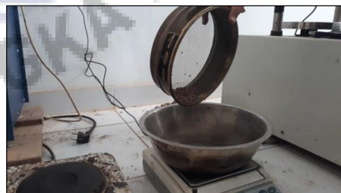
Gambar 23 Penimbangan tanah tertahan pada setiap saringan
