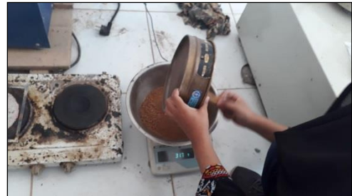
Gambar 30 Penimbangan tanah tertahan pada setiap saringan
