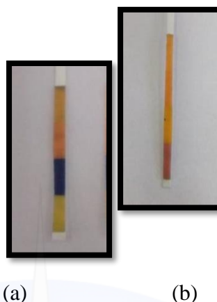
Gambar 4.6 Perubahan pH pada Limbah Batik Cual; (a) pH Sebelum Ditambahkan Asam nitrat, (b) pH Setelah Ditambahkan Asam Nitrat
