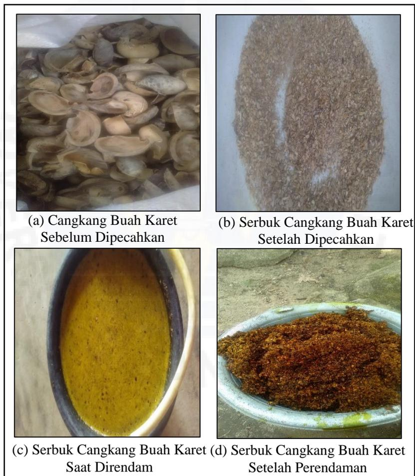
Gambar 4.5 Tahapan serbuk cangkang buah karet setelah perendaman NaOH
