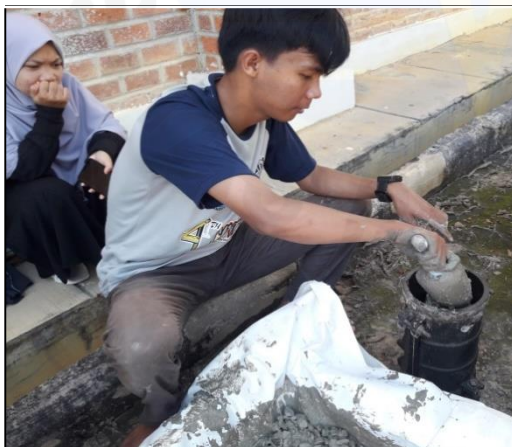
5. Masukkan beton segar kedalam silinder dan tusuk menggunakan batang penusuk
