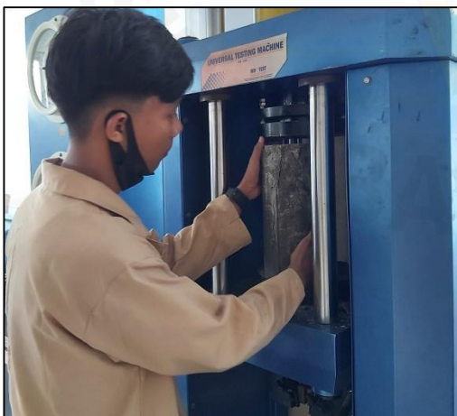
5. Beton dipasang pada alat uji tekan
