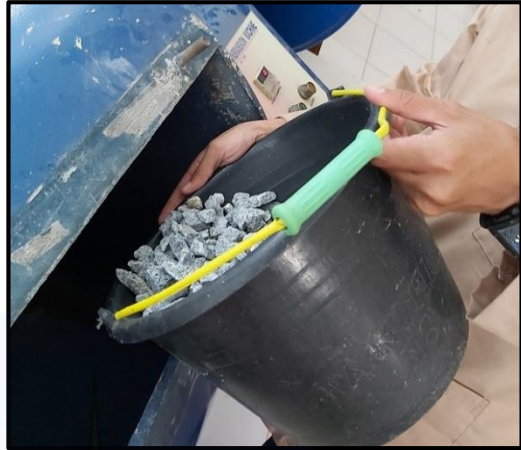
2. Masukkan agregat kasar kedalam mesin los angeles
