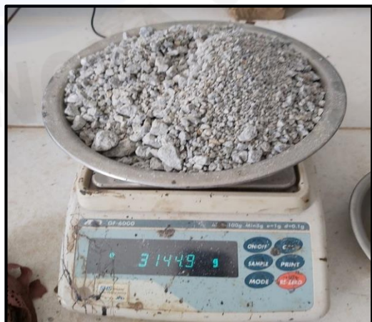
6. Saring menggunakan saringan no.12, lalu timbang dan catat hasil
