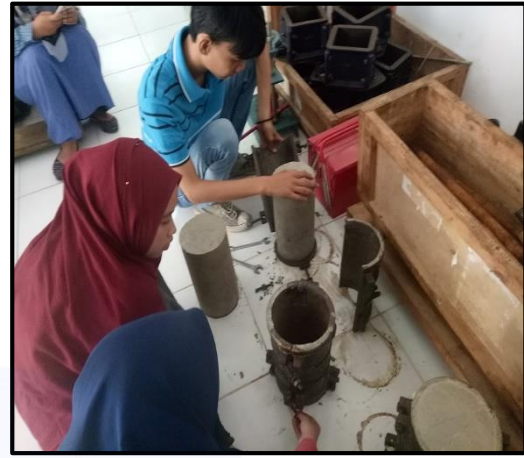
8. Lepaskan cetakan silinder
