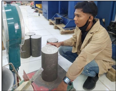
4. Beton ditimbang serta diukur diameter dan tinggi beton
