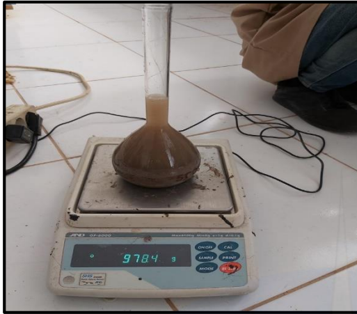
7. Timbang piknometer berisi air dan pasir
