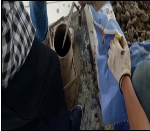
1. Masukkan beton segar kedalam kerucut slump
