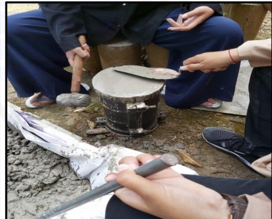
6. Pukul menggunakan palu karet agar tidak ada rongga di dalam silinder
