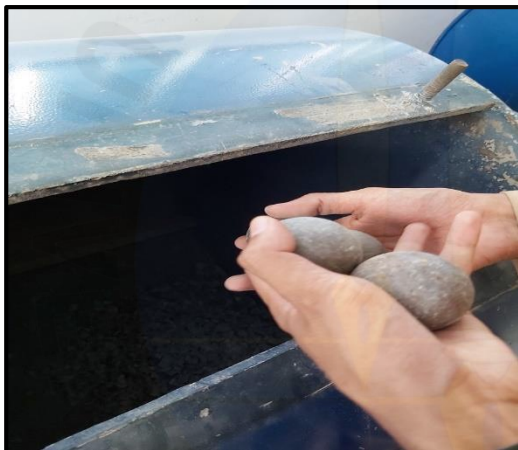
3. Masukkan 11 bola besi kedalam mesin los angeles
