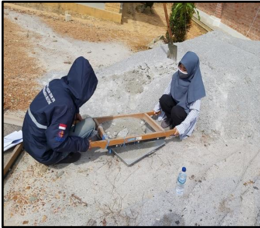
1. Penyaringan pasir dengan menggunakan saringan no.04
