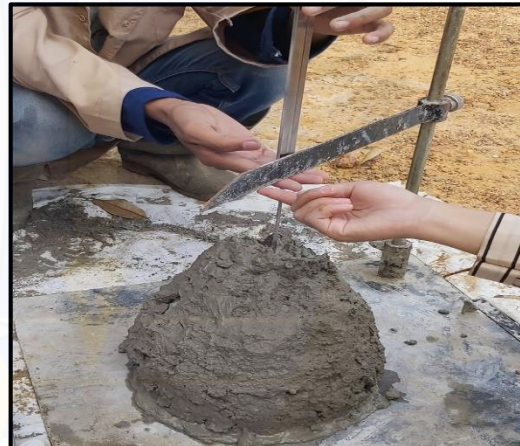
4. Ukur penurunan menggunakan penggaris
