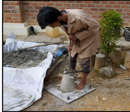
2. Tusuk kerucut slump menggunakan batang penusuk
