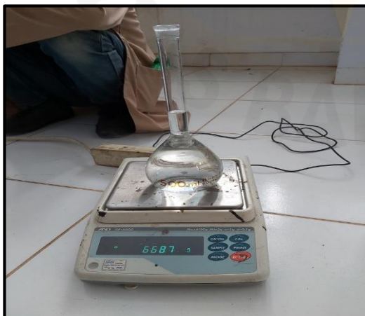
5. Timbang piknometer berisi air
