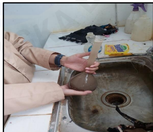
6. Masukkan pasir kedalam piknometer dan bersihkan sampai buih menghilang
