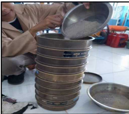
3. Tuangkan pasir kedalam saringan
