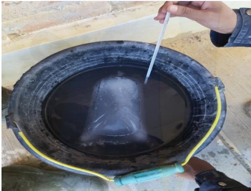
3. Untuk temperature dingin, air payau diberi es
