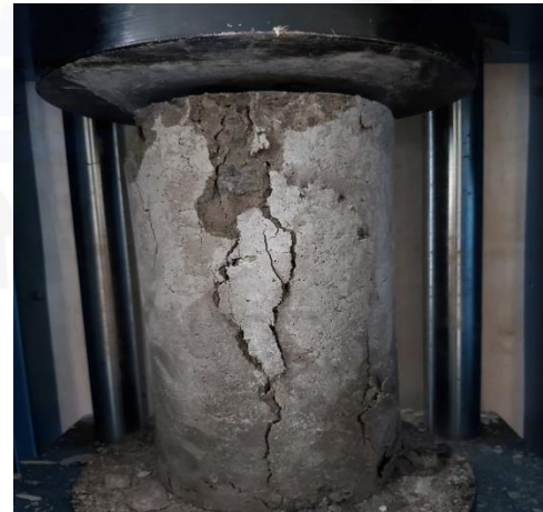
6. Kondisi beton setelah di Uji
