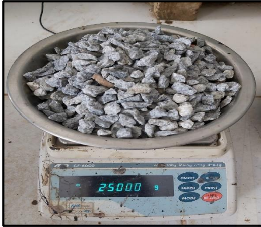
1. Timbang agregat kasar sebanyak 5000gr
