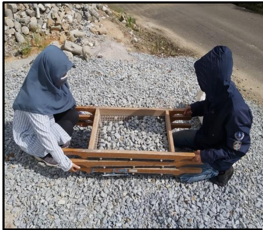
1. Penyaringan krikil dengan menggunakan saringan no. 3/4, no. 3/8 dan 4
