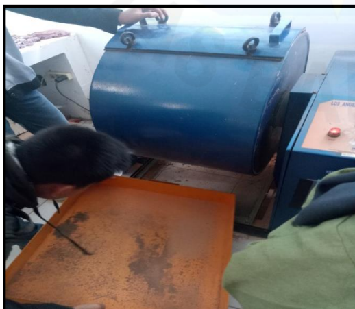
5. Keluarkan agregat kasar dari mesin los angeles
