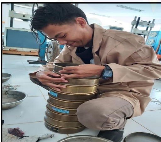
5. Goncangkan saringan selama 3 menit dan catat hasil
