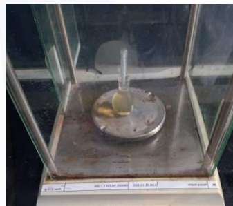
Gambar 22. Uji massa jenis etil
