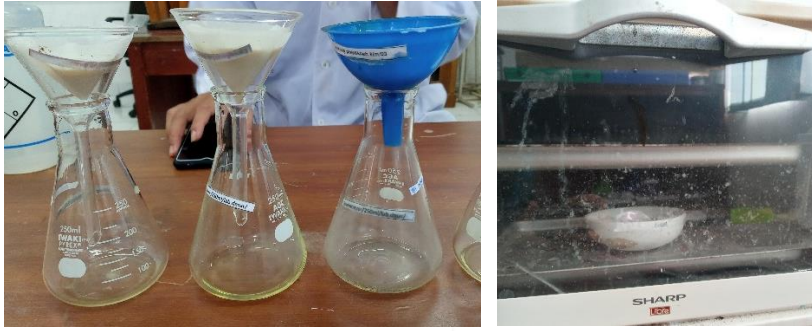
Proses Penyaringan dan Pengeringan Kaolin
