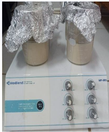
Penghomogenan Campuran Kaolin dan HCl
