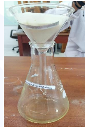
Penghomogenan Campuran Kaolin dan HCl
