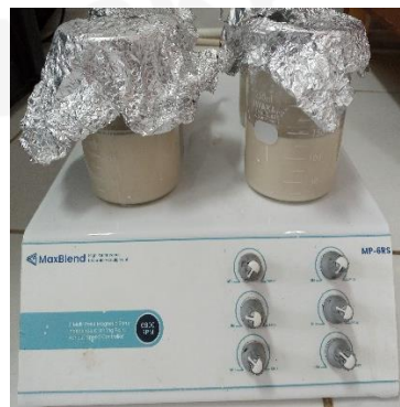
Penghomogenan Campuran Kaolin Dan HCl
