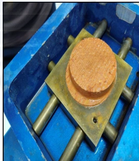
Gambar B.11 Bentuk Benda Uji Mengalami Pergesera
