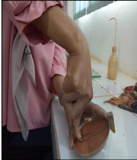
Gambar B.4 Pembuatan Alur Uji Batas Cair
