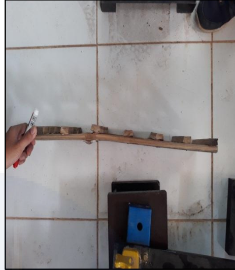
Gambar B.13 Benda Uji mengalami perubahan bentuk
