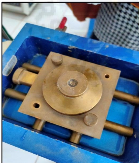
Gambar B.10 Proses Penguncian Benda Uji
