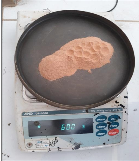
Gambar B.8 Sampel Tanah Lempung Pada Pengujian Berat Jenis
