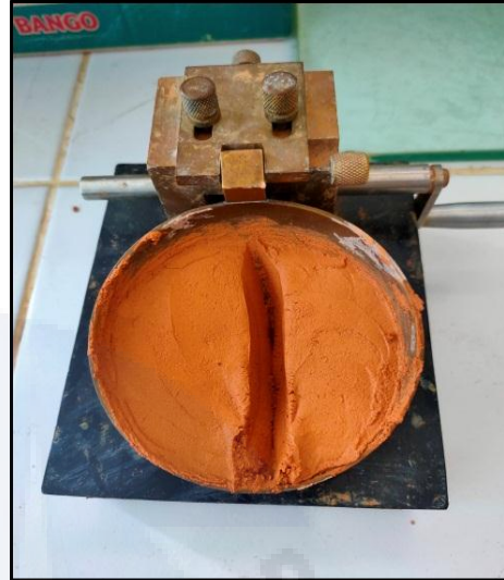
Gambar B.5 Pemasangan Benda Uji Pada Alat Casagrande
