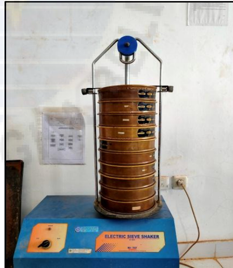
Gambar B.3 Pengguncangan Saringan Pada Mesin Sieve Shaker
