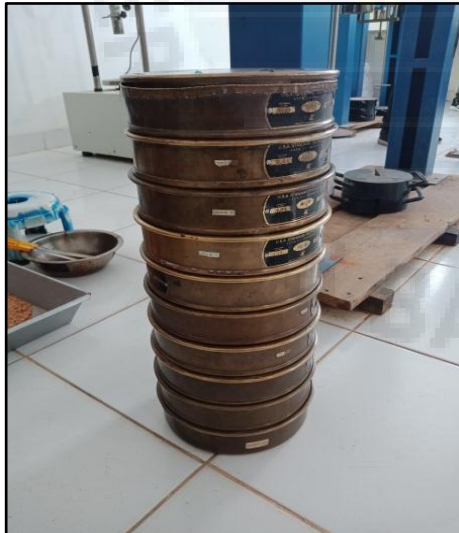
Gambar B.2 Saringan Yang Digunakan Pada Pengujian Analisis Saringan
