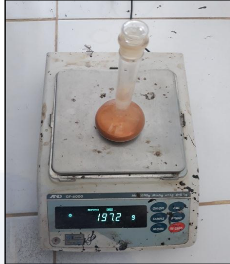
Gambar B.9 Proses Penimbangan Piknometer + Air + Benda Uji
