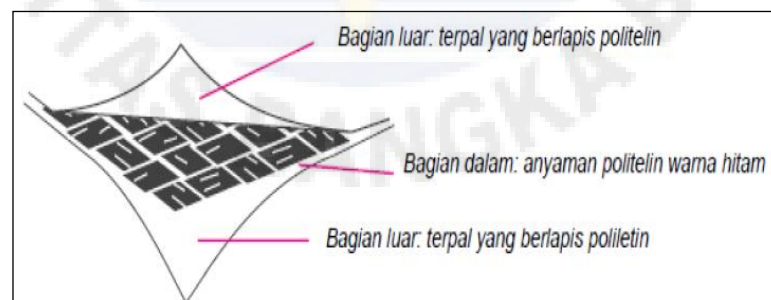
Gambar 2.10. Bagian-Bagian Lapisan Terpal Plastik
