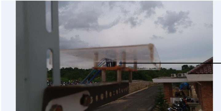
Alat ukur suhu, kelembaban, dan intensitas cahaya matahari
