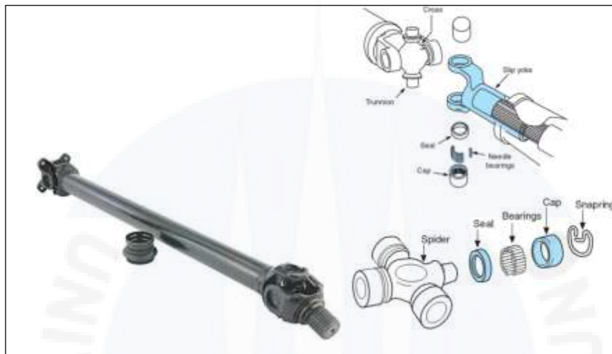
Gambar 1.2 Propeller shaft beserta komponen-komponennya (Sainan, 2013, pengertian dan fungsi universal joint )
