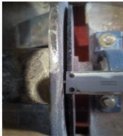
Gambar 1.1. Jarak corong input dan pisau
