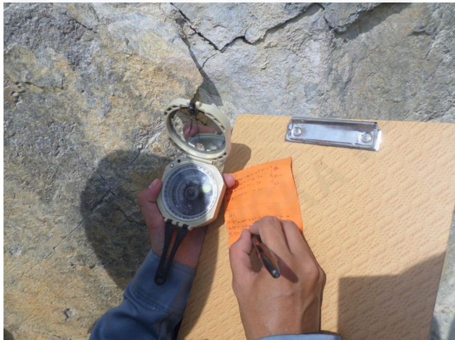
Gambar R.6 Pengukuran strike/dip
