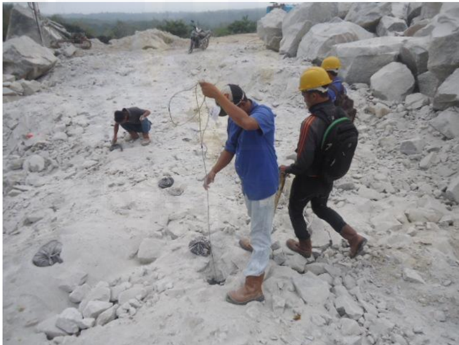
Gambar R.10 Pengecheckan ulang lubang bor ( sounding )
