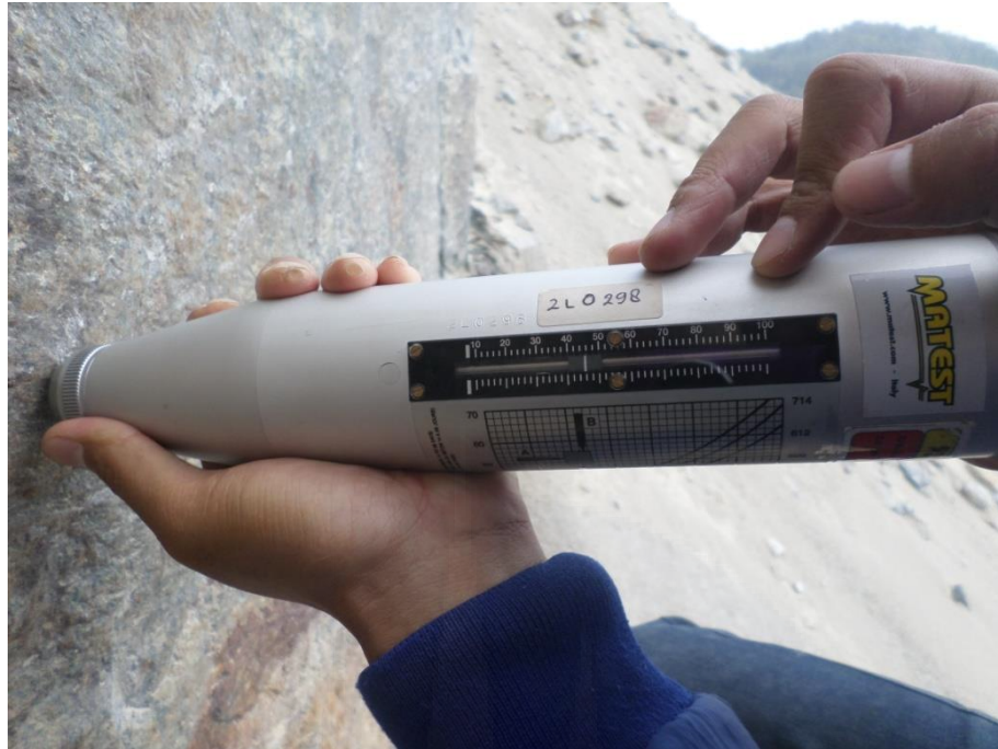
Gambar R.7 Uji Kuat Tekan menggunakan Schmidt Hammer
