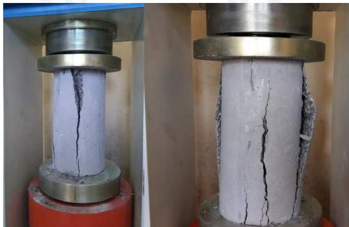
Gambar 5.13 Pola keretakan uji tekan beton tanpa serat dan beton dengan penambahan serat *polymer etilene braid*.
