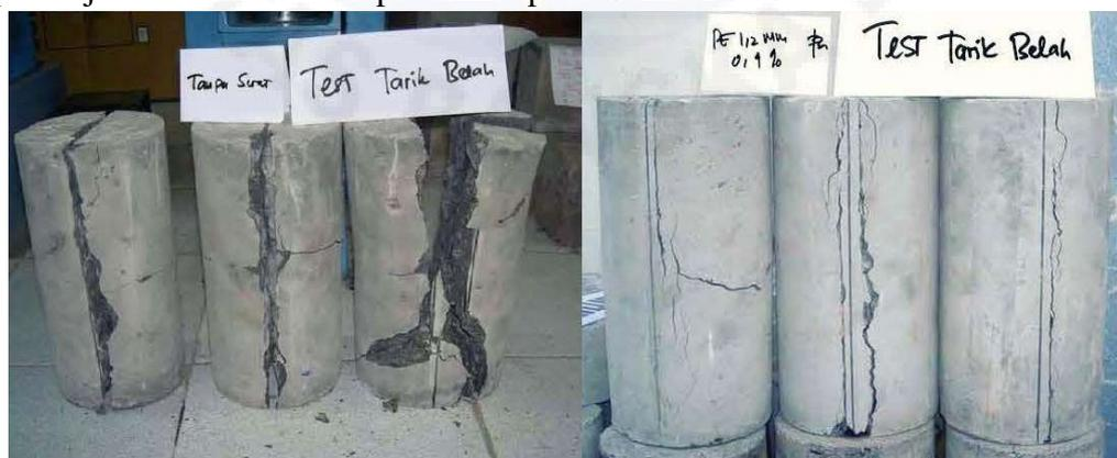
Gambar 5.15 Pola keretakan uji belah beton tanpa serat dan beton dengan penambahan serat *polymer etilene braid*
