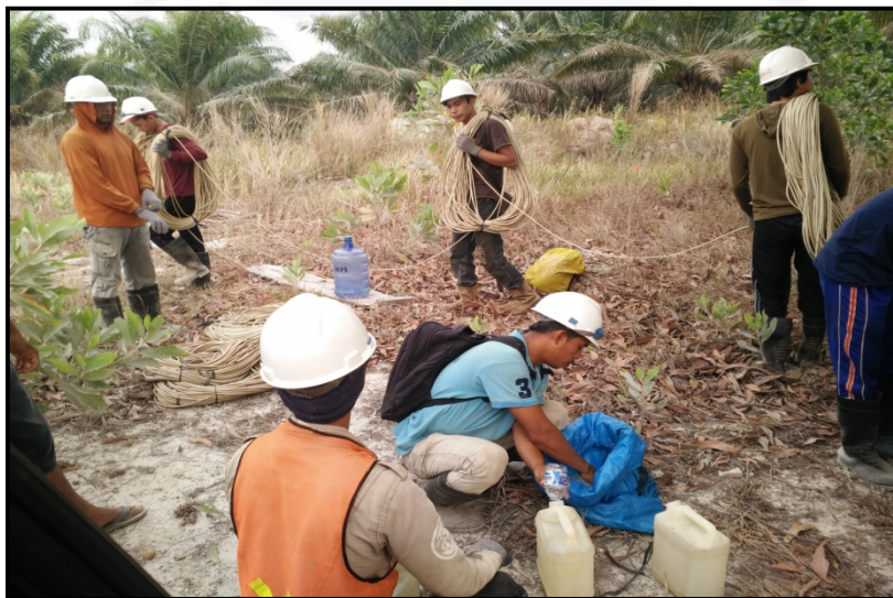
Gambar F.6 Proses pemasangan kabel elektroda
