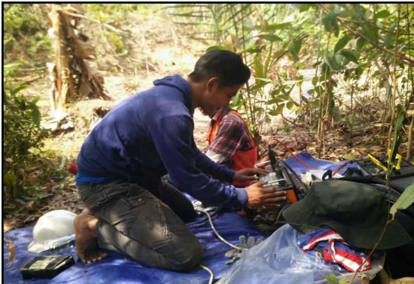
Gambar F.8 Proses pengaturan dan pengambilan data IP
