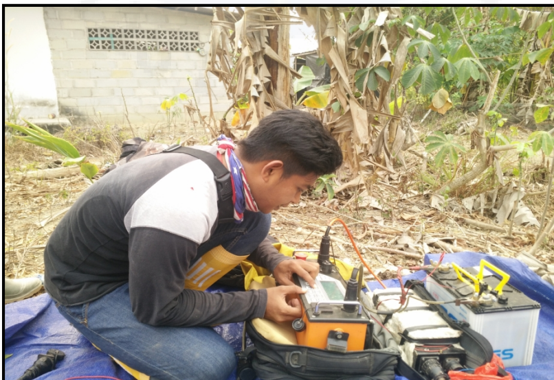
Gambar F.8 Proses pengaturan dan pengambilan data IP
