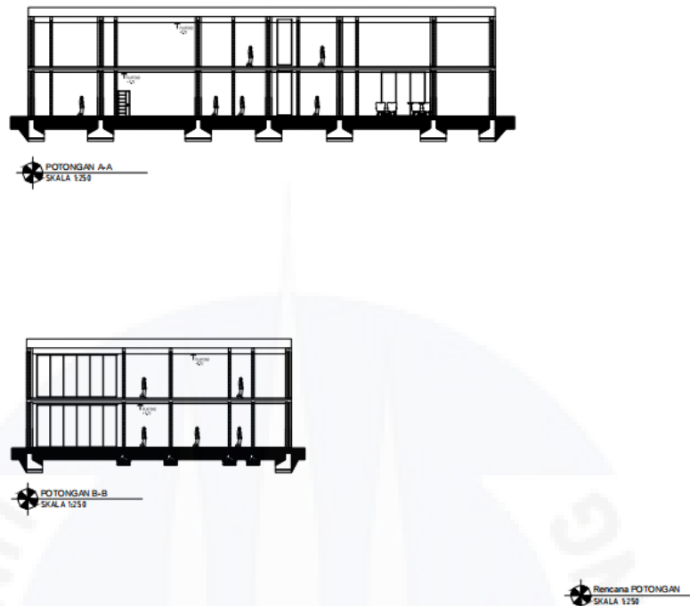
Gambar 6. 19 Potongan AA & BB Gedung Pengelola dan Administrasi (Sumber: Penulis 2026)
