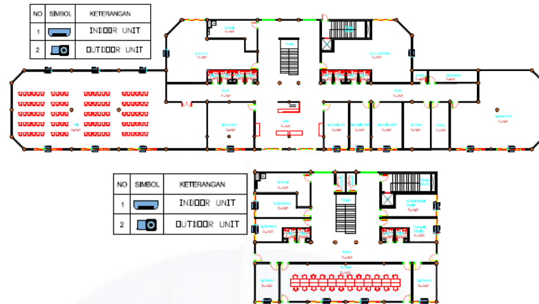
Gambar 6. 34 Sistem Penghawaan Bangunan Administrasi (Sumber: Penulis, 2026)
