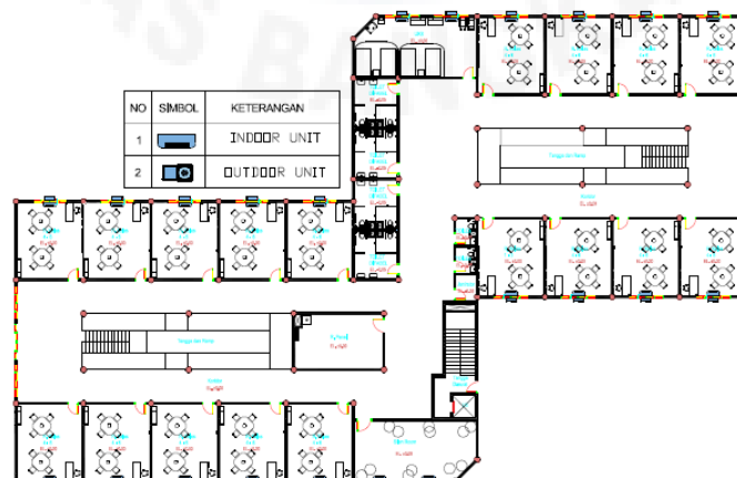
Gambar 6. 26 Sistem Penghawaan Bangunan Edukasi (Sumber: Penulis, 2026)
