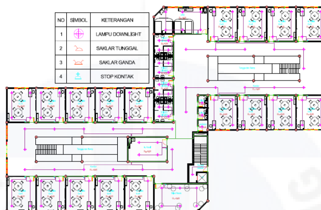
Gambar 6. 24 Elektrikal Bangunan Edukasi (Sumber: Penulis, 2026)
