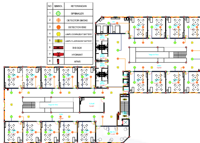
Gambar 6. 25 Sistem Kebakaran Bangunan Edukasi (Sumber: Penulis, 2026)
