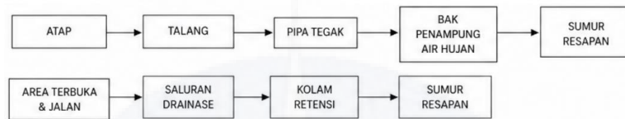
Gambar 5. 23 Sistem Drainase Air Hujan
