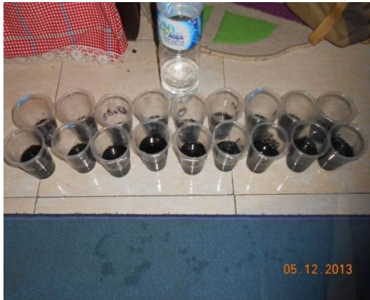
Perendaman Serat Rambut Manusia Menggunakan Larutan 5% NaOH Selama 60 Menit
