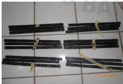
Benda Uji Tarik menurut Standard D-3039
