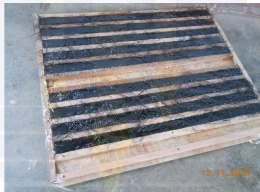
Pencetakan Benda Uji Tarik
