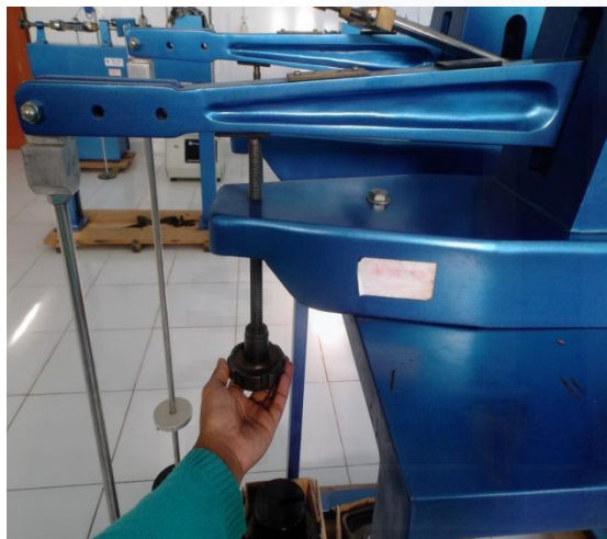
Gambar A.27 Penyetelan letak lengan pembeban agar membentuk sudut \pm 10^\circ & penguncian lengan pembeban serta pemberian beban
