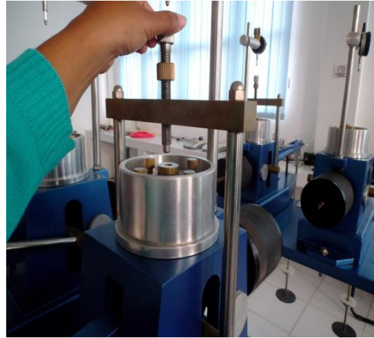
Gambar A.26 Penyetelan sekrup penekan agar menekan benda uji secara sentris
