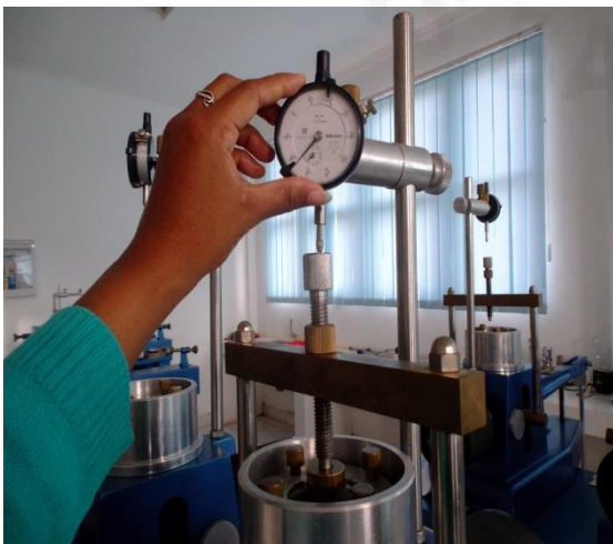
Gambar A.29 Penyetelan arloji ukur gerak vertikal agar tepat menyentuh dudukan sekrup penekan
