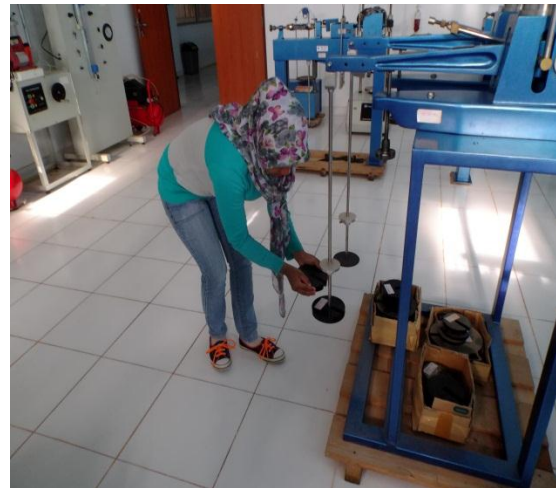
Gambar A.32 Penambahan beban setelah pengujian 24 jam
