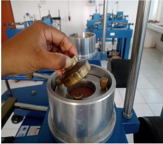
Gambar A.25 Pemasangan landasan & batu pori bagian atas
