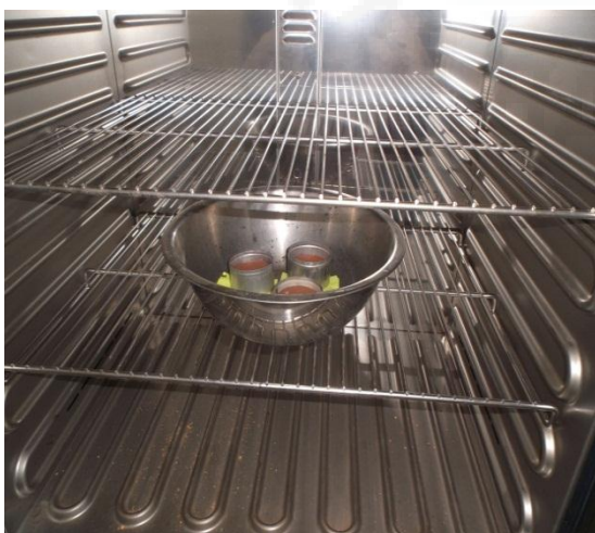
Gambar A.35 Benda uji setelah pengujian di oven selama \pm 18 jam
