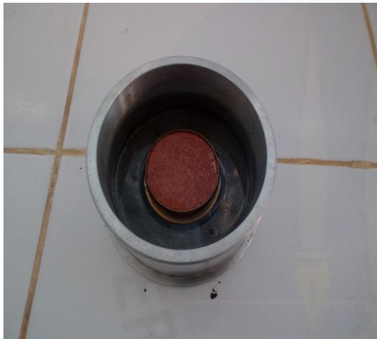
Gambar A.33 Pengeluaran sampel dari alat uji, ditimbang kemudian oven selama \pm 18 jam
