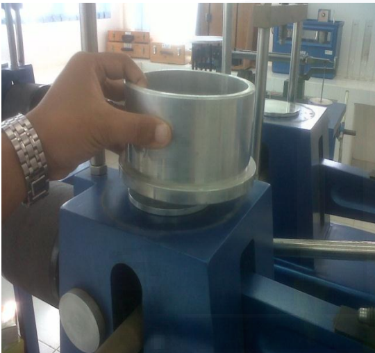
Gambar A.21 Pemasangan landasan bawah
