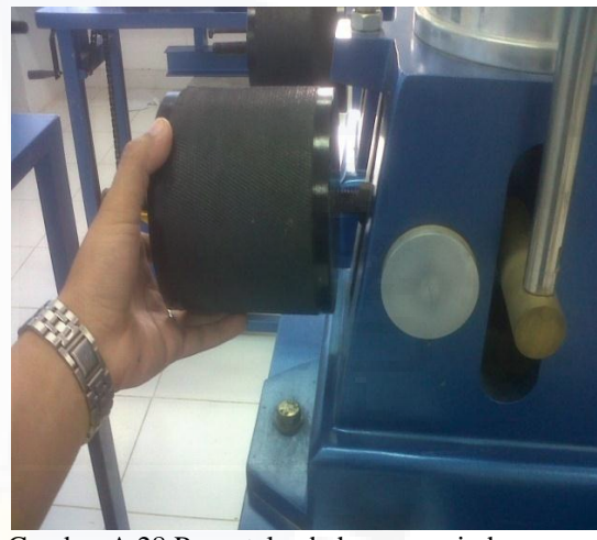
Gambar A.28 Penyetelan beban penyeimbang agar lengan pembeban tetap membentuk sudut 10^\circ
