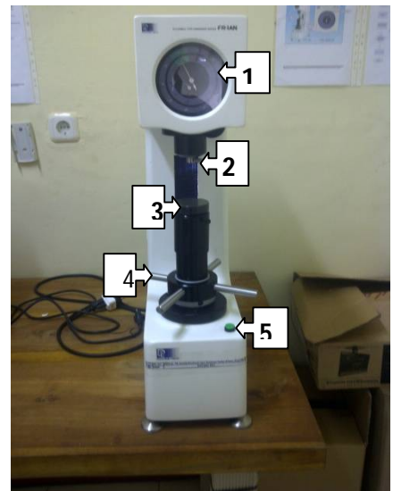
Gambar mesin Uji Kekerasan ( Rockwell ) yang digunakan untuk mengukur kekerasan pada spesimen penelitian.
