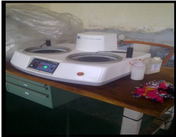
Mesin Polishing yang digunakan untuk memoles benda kerja
