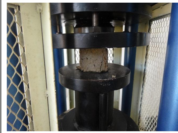
Gambar. Pembebanan kubus 0%
