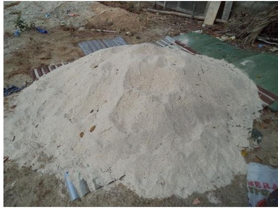
Gambar. Pasir Pantai
