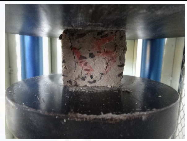
Gambar. Pembebanan kubus 5%
