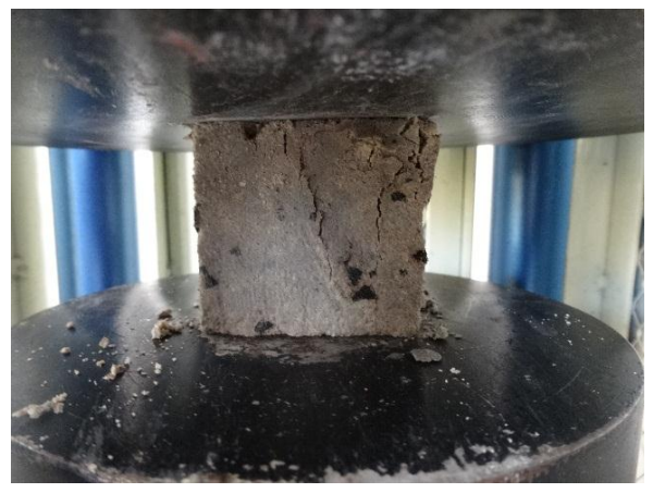
Gambar. Pembebanan kubus 5%
