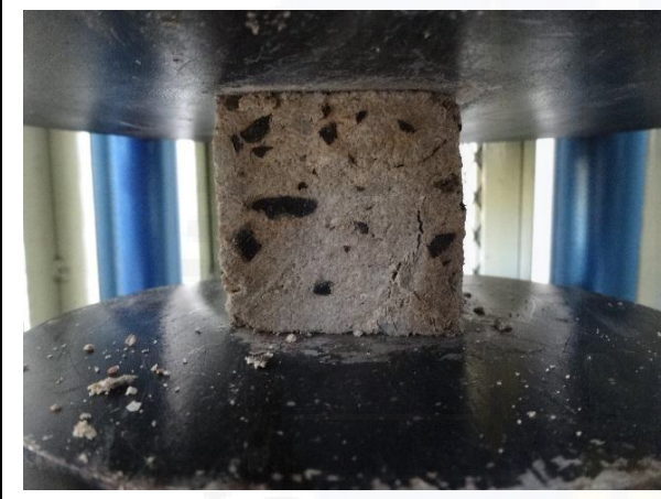
Gambar. Pembebanan kubus 0%
