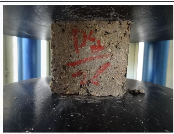
Gambar. Pembebanan kubus 5%
