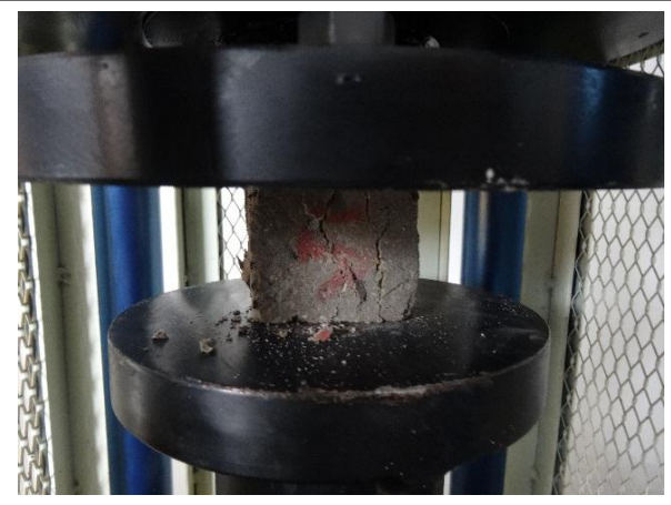
Gambar. Pembebanan kubus 5%
