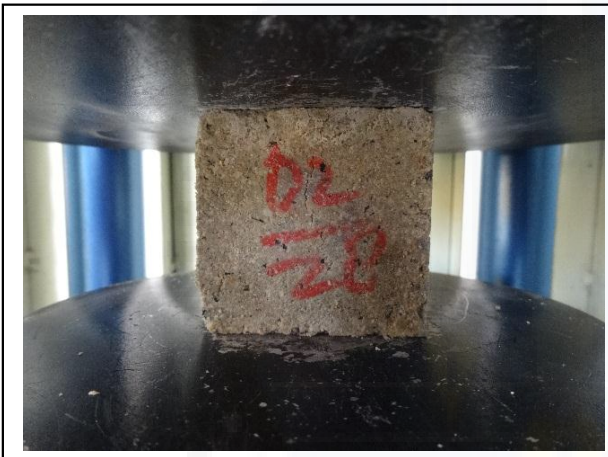
Gambar. Pembebanan kubus 0%
