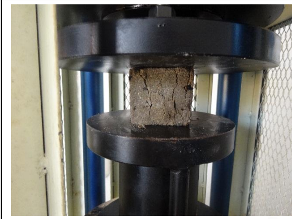
Gambar. Pembebanan kubus 0%
