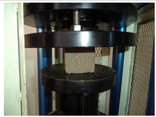
Gambar. Pembebanan kubus 5%
