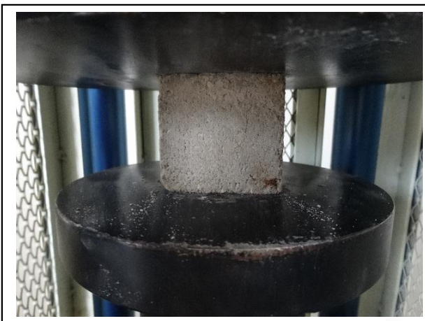
Gambar. Pembebanan kubus 0%
