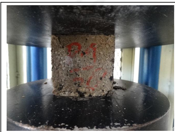
Gambar. Pembebanan kubus 10%
