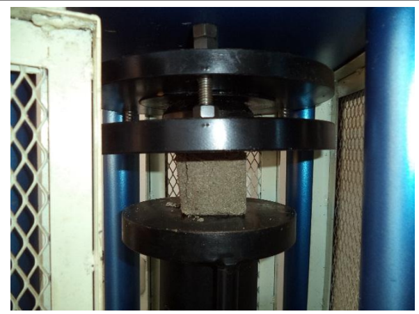
Gambar. Pembebanan kubus 5%
