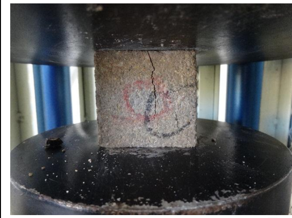
Gambar. Pembebanan kubus 0%
