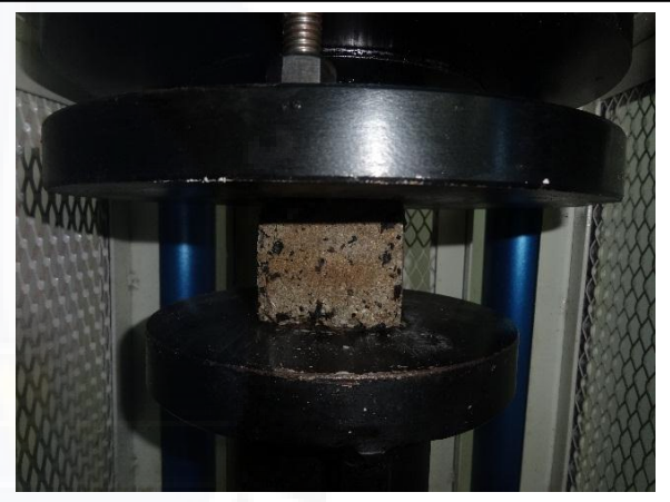
Gambar. Pembebanan kubus 5%
