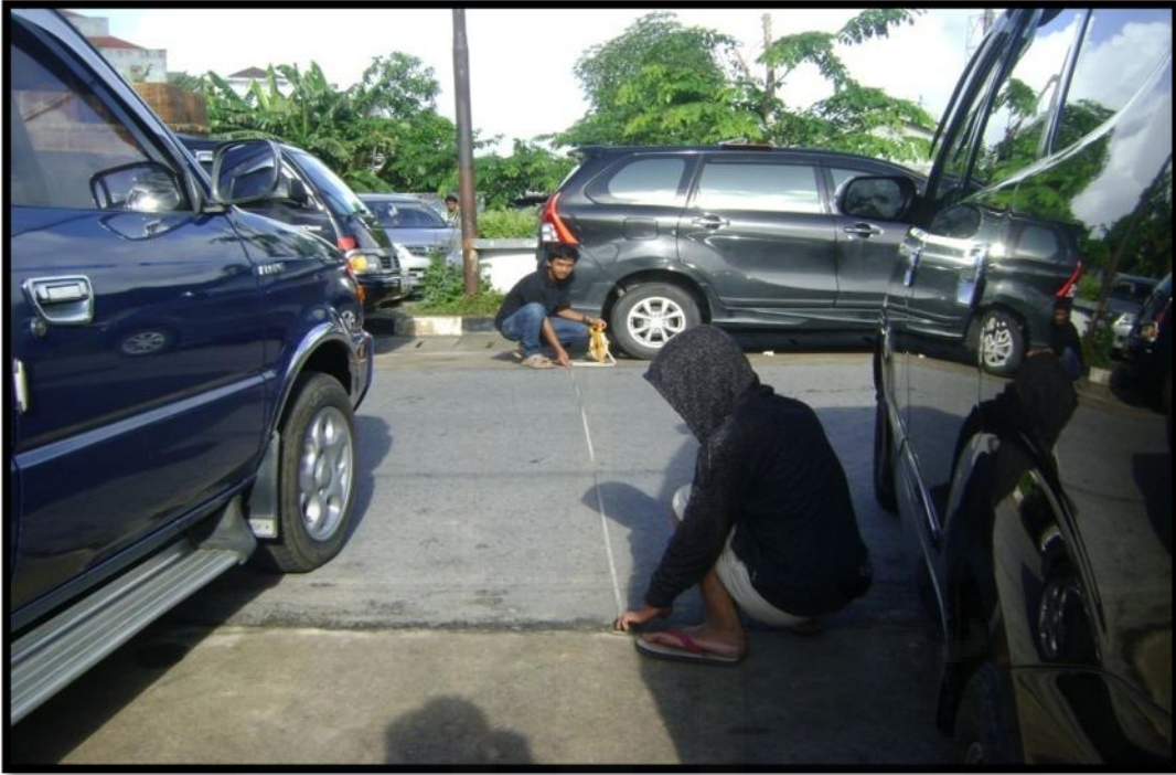
Foto Pengambilan Data Geometrik Jalan
