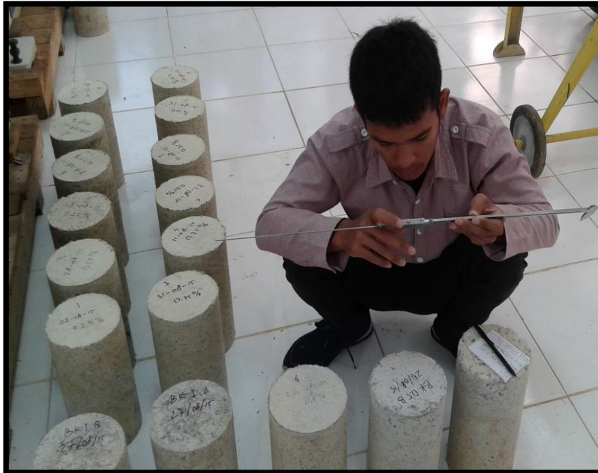
Gambar 5.43 Proses pengukuran dimensi benda uji
