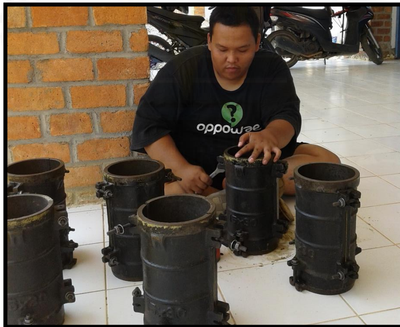
Gambar 5.36 Pengisian oli pada cetakan tabung silinder
