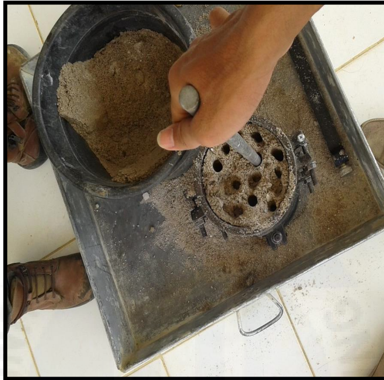
Gambar 5.29 Pengujian berat isi agregat halus padat
