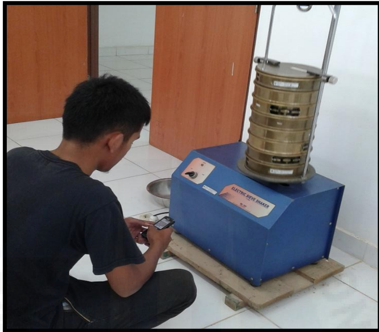
Gambar 5.27 Pengujian analisa saringan agregat halus
