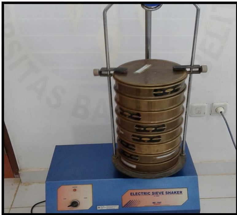
Gambar 5.28 Pengujian analisa saringan agregat halus
