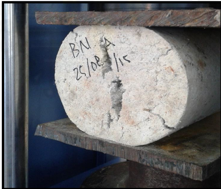
Gambar 5.50 Pola keretakan pada pengujian kuat tarik belah beton kertas normal
